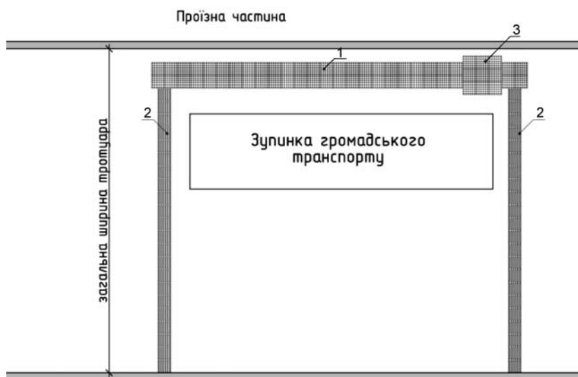
Рисунок 20 – Приклад можливого застосування ТС на зупинках громадського транспорту поблизу споруди ЦЗ: 1 – попереджувальна ТС; 2 – інформаційна ТС; 3 – інформаційна ТС, що вказує місце посадки/висадки в міський транспорт (відповідно до ДБН В.2.2- 40:2018)
