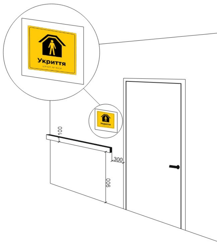
Рисунок 22 – Приклад розміщення тактильних інформаційних покажчиків споруд ЦЗ: 1 – інформаційна направляюча; 2 – тактильна інформаційна позначка; 3 – інформаційна тактильна табличка, що дублює текстову інформацію у тактильному вигляді плоско друкованого тексту та шрифтом Брайля
